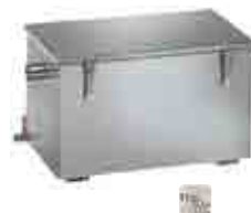
61352 Mobiler Fettabscheider 132l Fettabscheideraum 132l Schlammfang 52l exkl. Entsorgung Zu- und Ablauf DN50 Maße (H/B/T) 62/82/53cm 119,90 142,68
